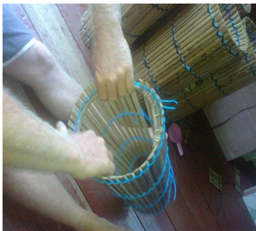
Figura 10: Introdução da estachama (arco)
