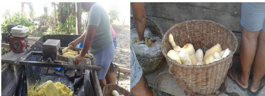
Figuras 11: Ralamento da Mandioca para a Fabricação da Farinha na Comunidade Indígena de Feijoal
