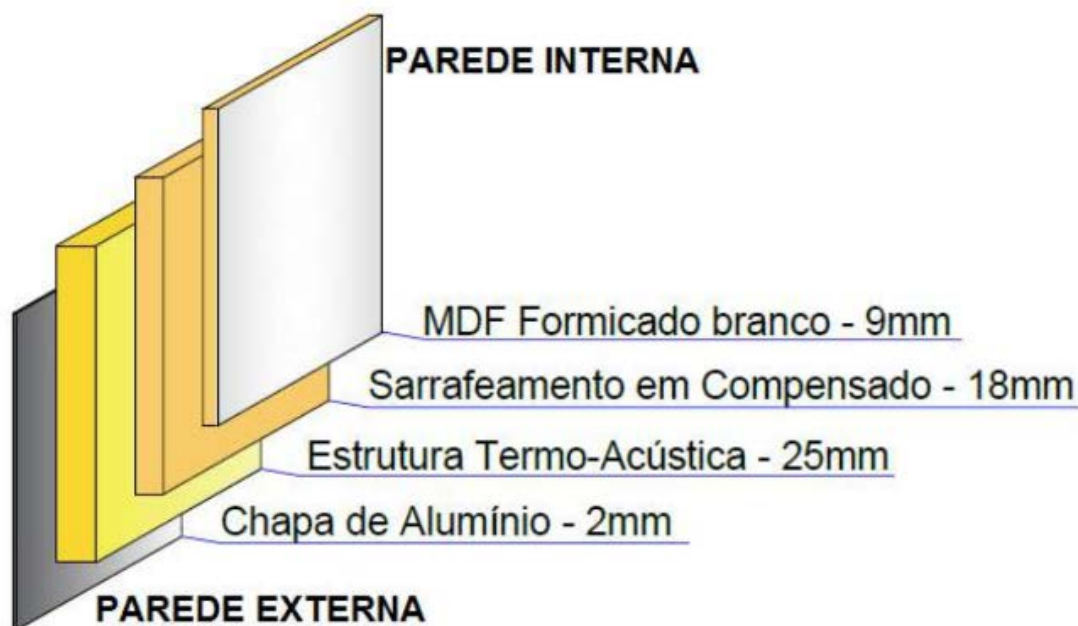
Figura 01 – Camadas e espessuras dos revestimentos.
