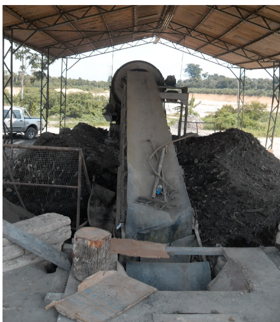
Fig. 7: Equipamento quebrado. Utilização de peneira manual para a realização dos serviços.
